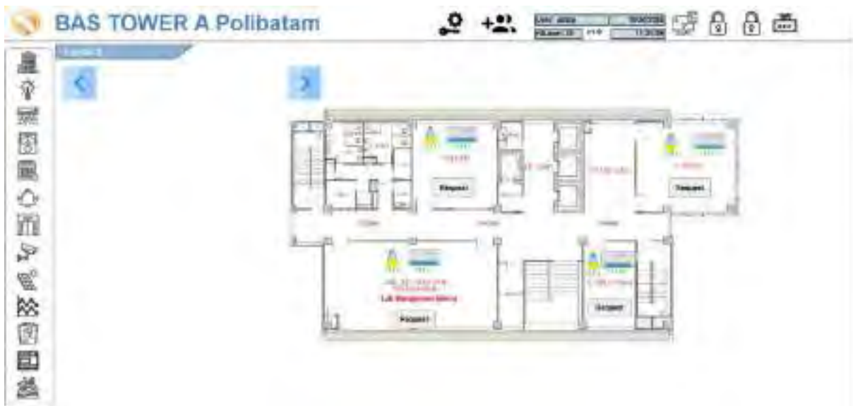
BAS (Building Automation System) untuk on off lampu otomatis
